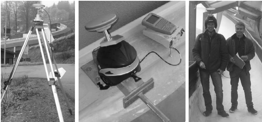
Abb. 2: Erhebung der geografischen Koordinaten der Rennstrecke in Winterberg mittels differenziellem GPS. Links: Basisstation zur Fehlerkorrektur von atmosphärisch bedingten Laufzeitverzerrungen der Satellitensignale. Mitte: Mobile Empfangseinheit und Datenlogger. Rechts: Abgehen der Rennstrecke auf der geschätzten Fahrlinie. Der Höhenoffset von 2 m wurde in Nachbearbeitung von der z-Koordinate abgezogen.
